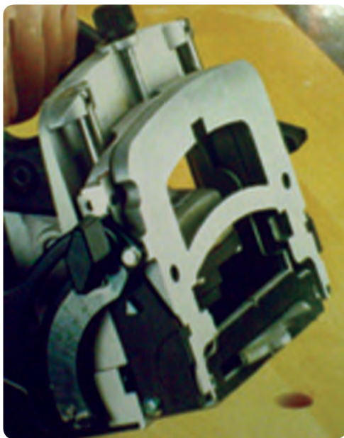
شکل ۲-۹۲ نشان دهنده موقعیت تیغه روی دستگاه
