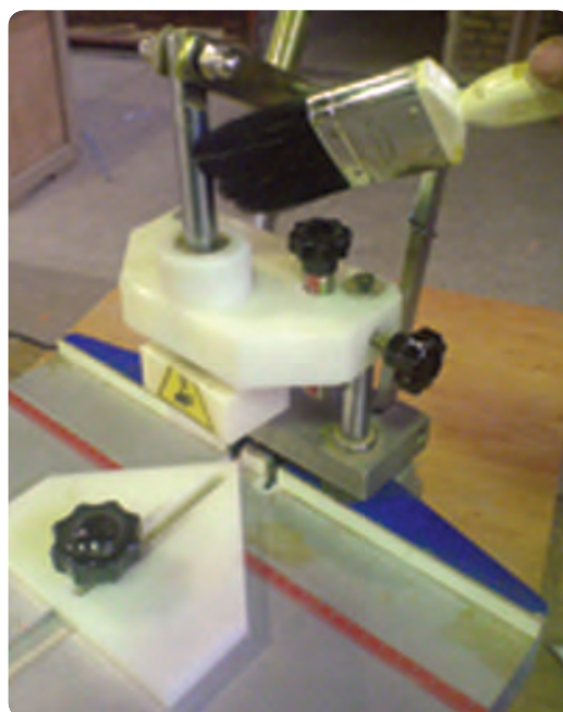
شکل ۱۱۶-۲ تمیز کردن مفصل‌های حرکتی ماشین دم چلچله‌زن
