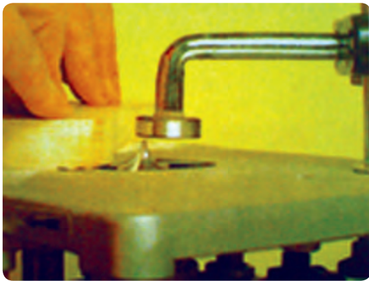
شکل ۶۵-۲ بلبرینگ هدایت برای قطعات قوس‌دار
