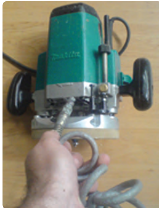
شکل ۲-۷۱ بادگیری دستگاه پس از پایان کار
