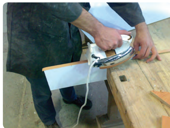
شکل ۱۴۷- اتوکشی نوار روکش لبه‌چسبان
