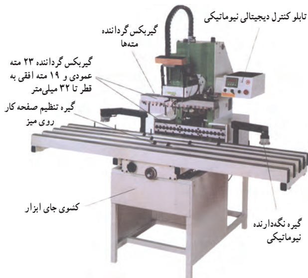
ماشین سوراخ‌زنی و لولازنی دیجیتالی نیوماتیک
