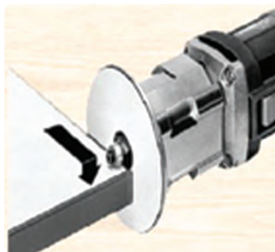
شکل ۱۵۵-۲ پرداخت لبه‌های اضافی روکش مصنوعی
