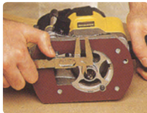
شکل ۲-۶۸ اندازه‌گیری قطر شفت فرز
