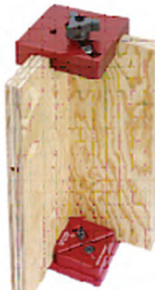
شکل ۳-۳۶ مونتاژ پانل‌های عمودی
