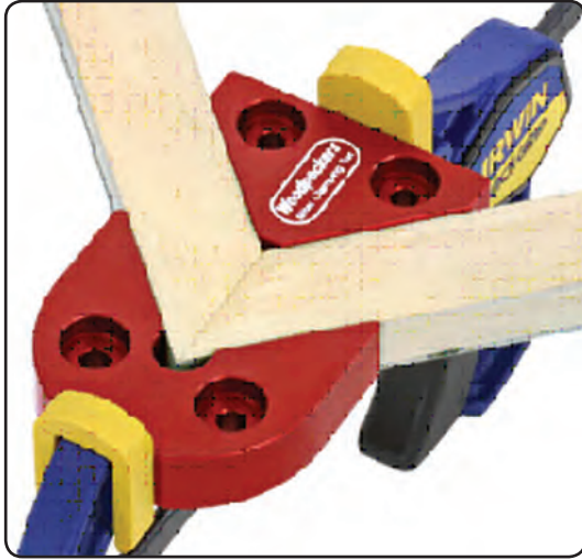
شکل ۳-۳۳ فیکسچر جهت مونتاژ قاب به حالت افقی
