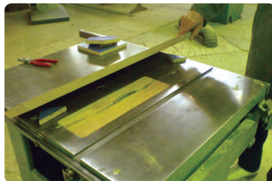
شکل ۳-۳۹ قرار دادن دو عدد زیرسری برای ساخت گونیا
