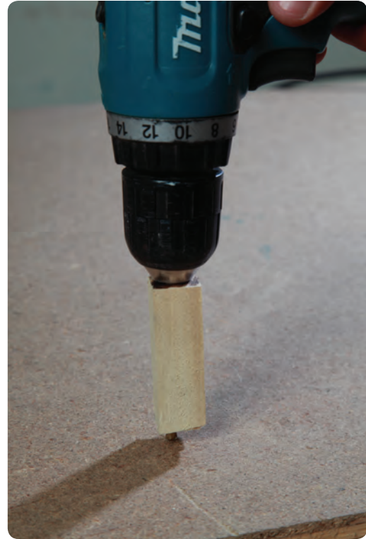
شکل ۳-۳۲ سوراخ دریل قطعه کنترل اندازه عمق
