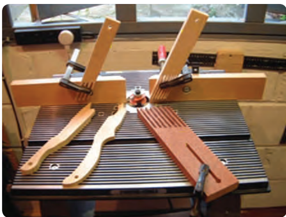
شکل ۳-۲۸ شانه‌های حفاظتی به صورت عمودی
