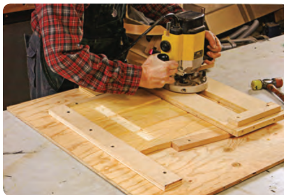
شکل ۳-۲۹ شابلون تسریع‌کننده و حفاظتی اورفرز
