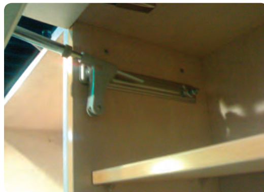
شکل ۶-۳۷ در کابینت نصب شده با نگهدارنده پمپی
