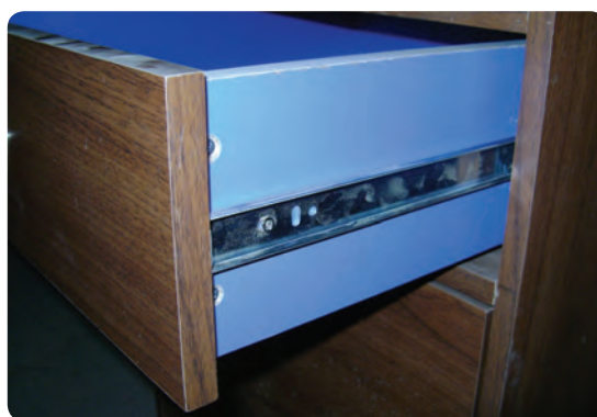
شکل ۵۶-۶ ریل مکانیکی نصب شده در بدنه جعبه
