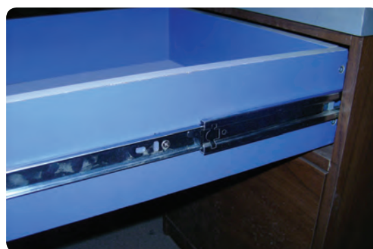
شکل ۵۷-۶ ریل مکانیکی دو مرحله‌ای
