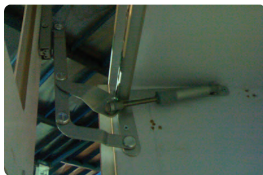
شکل ۶-۳۸ در کابینت نصب شده با جک اتوبوسی
