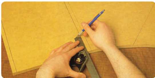
شکل ۲۸-۸ خط‌کشی محل قرارگیری بدنه‌ها در زیر صفحه میز
