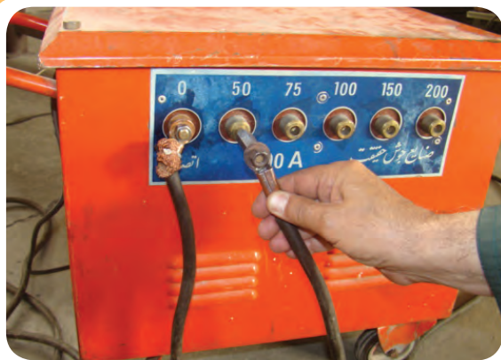
تنظیم آمپر در دستگاه ترانسفورماتور پله‌ای
