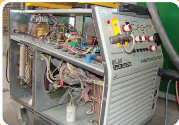
سیستم الکترونیکی تبدیل جریان متناوب بر جریان مستقیم در رکتی‌فایرهای جوشکاری
