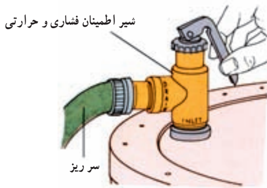
شکل ۲-۱۰۹- شیر اطمینان فشاری - حرارتی
