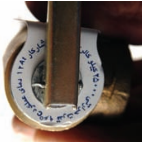
شکل ۲-۱۰۸- شیر اطمینان فشاری و حرارتی
