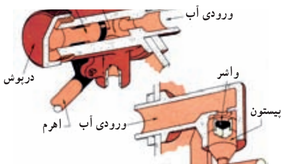
شکل ۱۱۳-۲ اجزای شیر شناور
