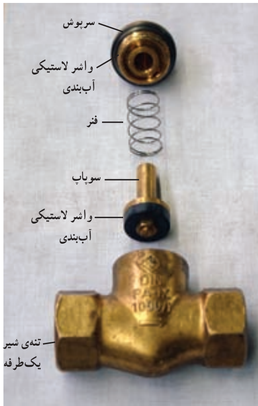
شکل ۲-۱۰۱- اجزای شیر یک طرفه‌ی سوپاپی
