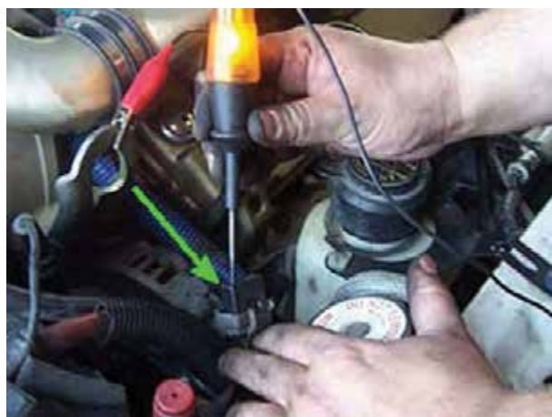
شکل ۱-۷۳- آزمایش سیم کشی مدار
