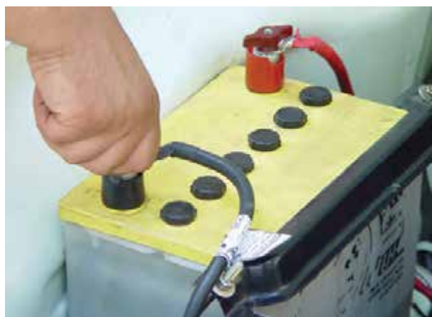
شکل ۱-۴۹- باز کردن اتصال بدنه باتری
