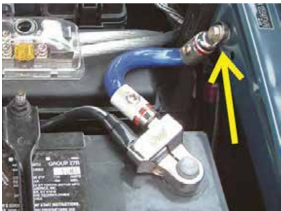
شکل ۲-۲۴ اتصال کابل منفی باتری به بدنه
