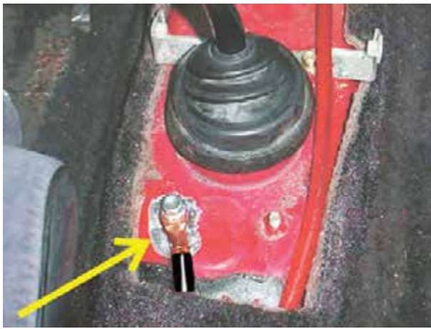
شکل ۲-۲۵- اتصال بدنه‌ی باتری در داخل اتاق خودرو
