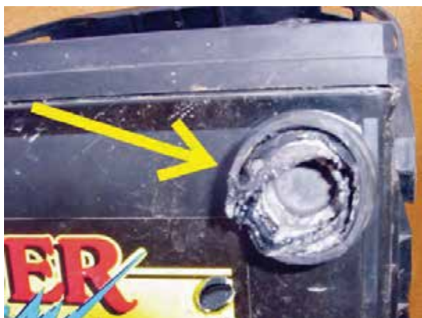
شکل ۳۶-۲- معیوب بودن ترمینال باتری
