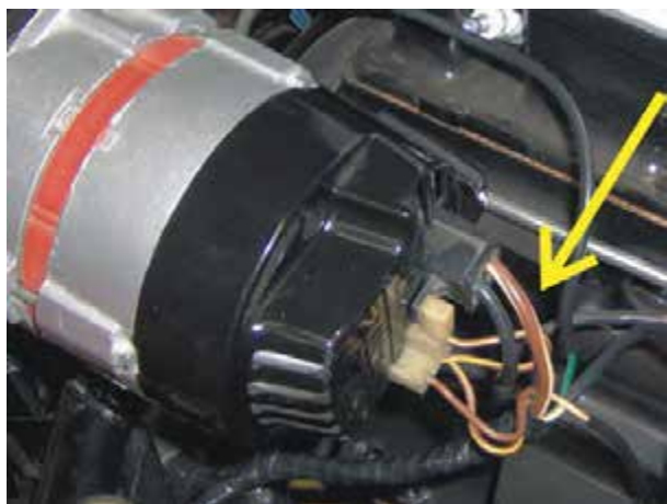
شکل ۳-۲۱- کد رنگ سیم‌های استفاده‌شده در مدار شارژ یک نوع خودرو
