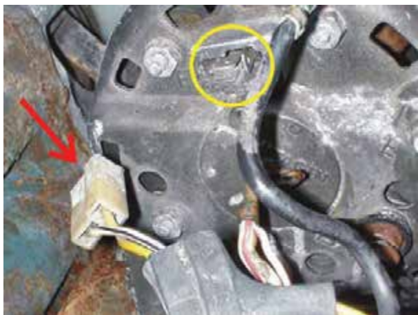
شکل ۳-۳۵- جدا کردن کاتوجویی سیم کشی لامپ شارژ
