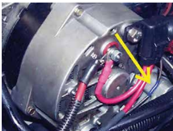
شکل ۳-۲۶- عایق کاری سیم کشی مدار الکتریکی
