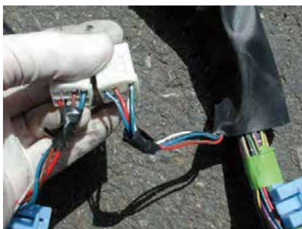
شکل ۳-۲۳- مقایسه و تطبیق سوکت‌های کلاف سیم‌کشی
