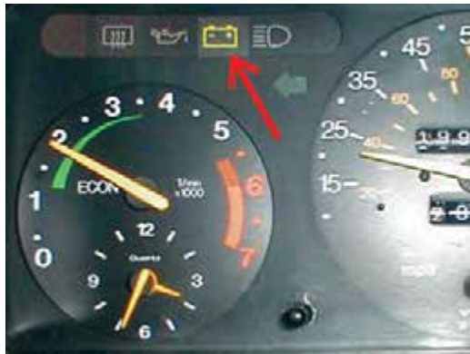
شکل ۱۰-۳ لامپ شارژ یک نوع خودرو
