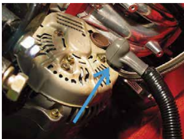
شکل ۳-۲۴- عایق اتصال الکتریکی ترمینال آلترناتور
