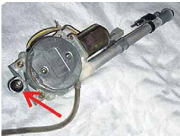
شکل ۵-۲۲- آنتن الکتریکی بس از پیاده کردن آن
