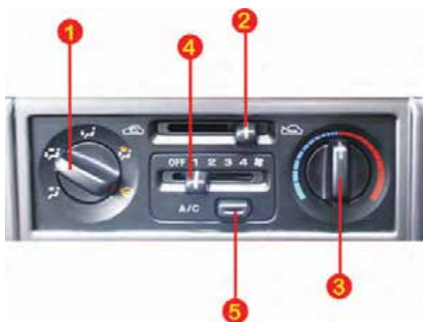
شکل ۲۴-۵- اهرم‌های تنظیم روی پانل راننده
