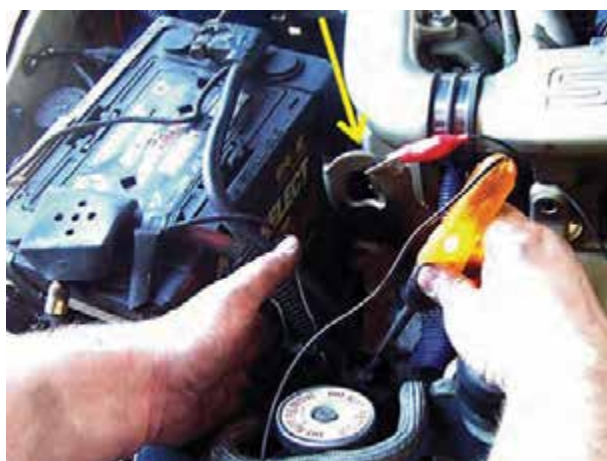
شکل ۴۳-۵- نحوه‌ی آزمایش سالم بودن سیم‌کشی
