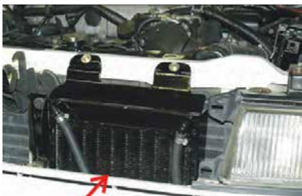
شکل ۵-۱۳- کندانسور نصب شده در یک نوع خودرو
