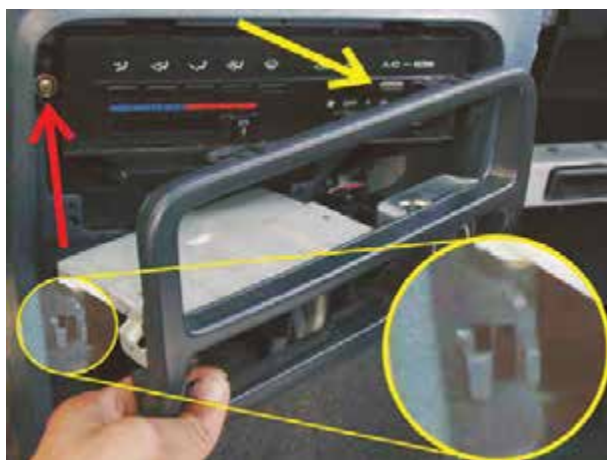
شکل ۳۸-۵- باز کردن قاب سوئیچ‌ها
