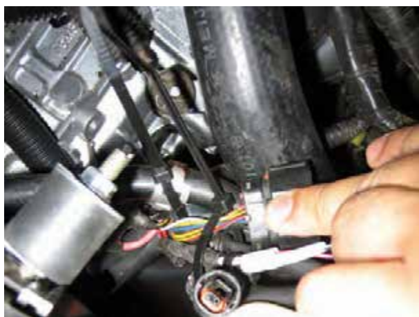
شکل ۴۵-۵- بررسی اتصالات الکتریکی سیم‌کشی
