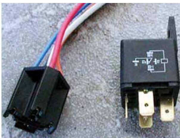
شکل ۷-۱۳- یک نوع رله یا آفتامات بوق
