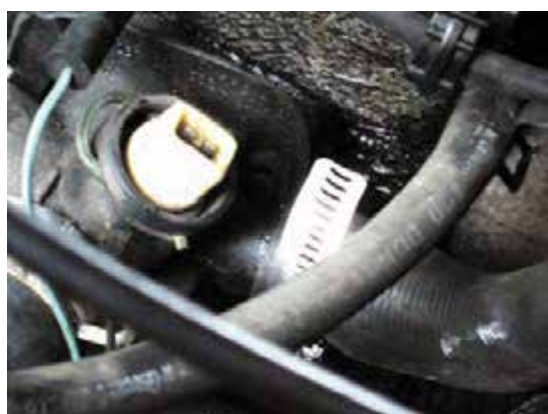
شکل ۲۵-۶- ترمینالهای سنسور حرارتی مدار خنک کاری
