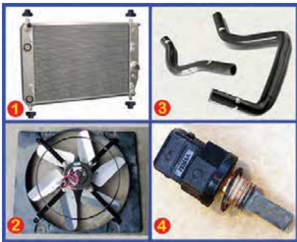
شکل ۲-۶- اجزای مدار خنک کاری
