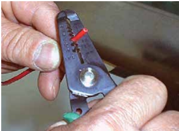
شکل ۶-۳۰- جدا کردن عایق سیم
