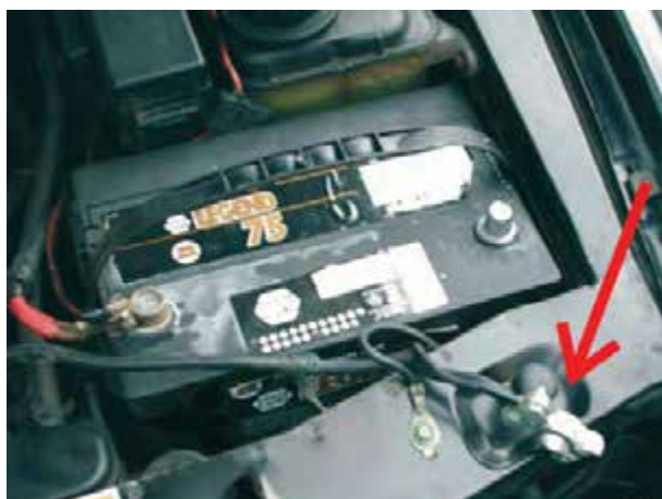
شکل ۱۵-۶- جدا کردن بست کابل اتصال بدنه‌ی باتری
