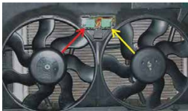
شکل ۱۱-۶- رله ی فن ها
