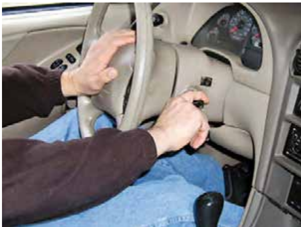
شکل ۴۵-۷- روشن کردن موتور
