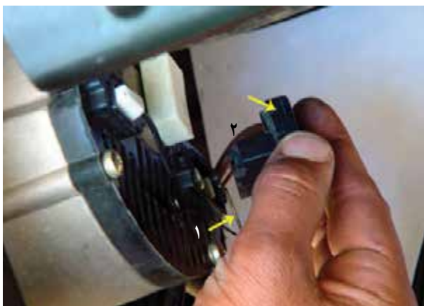
۱- خار ۲- مغزی اتصال سیم شکل ۵۰-۷ جدا کردن خار و مغزی اتصال سیم از آلترناتور
