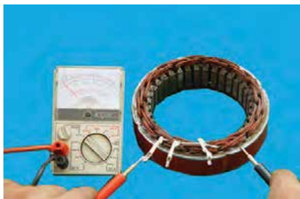
شکل ۷-۷۸ - آزمایش اتصال بدنه نبودن سیم پیچ استاتور
