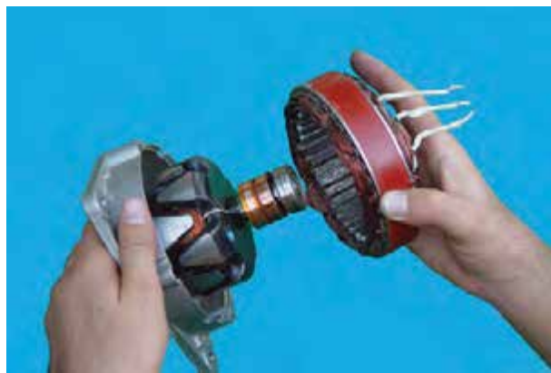
شکل ۶۲-۷ - جدا کردن استاتور
