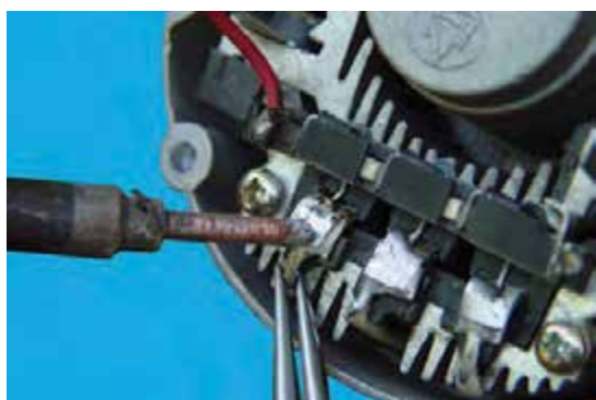
شکل ۷-۵۶- جدا کردن سیم‌های استاتور از یک‌سوکننده
