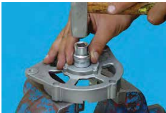
شکل ۶۹-۷ - بیرون آوردن بلبرینگ
