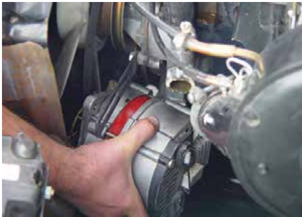
ب - بیرون آوردن آلترناتور از موتور
