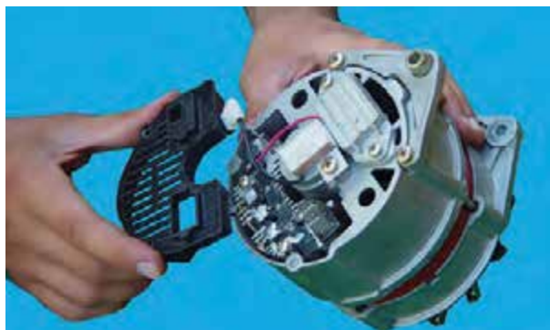
شکل ۵۲-۷- بازکردن درپوش دیودها
