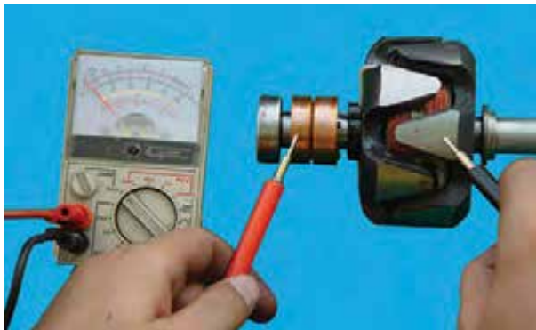
شکل ۷۴-۷- آزمایش اتصال بدنه نبودن سیم پیچ روتور
