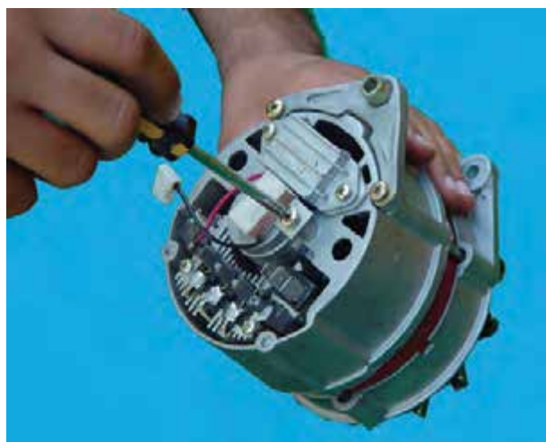
شکل ۵۳-۷- بازکردن پارازیت گیر
