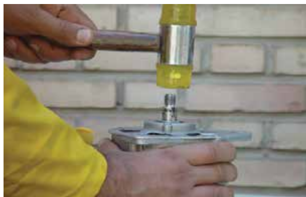
شکل ۶۳-۷ - بیرون آوردن روتور از درپوش
