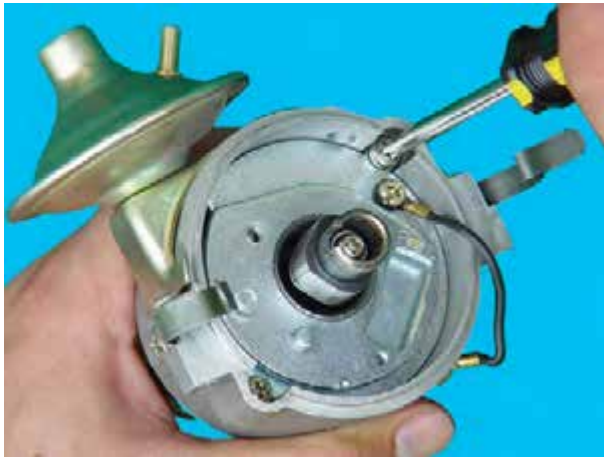
شکل ۱۹-۱۰- باز کردن پیچ‌های صفحه‌ی دلکو
