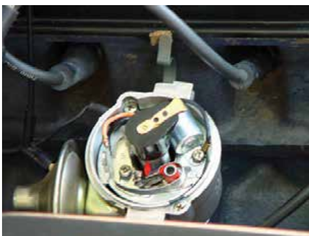
شکل ۵۵-۱۰- راستای چکش برق به سمت سیلندر یک
