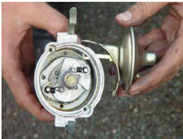
شکل ۳۱-۱۰ جدا کردن مجموعه‌ی آوانس خلئی
