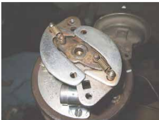
شکل ۲۴-۱۰- دستگاه آوانس وزنه‌ای دلکو
