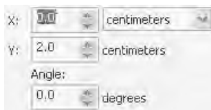
شکل ۱۹-۲ ایجاد خطوط راهنما با مختصات یک نقطه و زاویه خط
