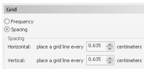
شکل ۲۸-۲ استفاده از گزینه Spacing برای تعیین فاصله خطوط Grid
