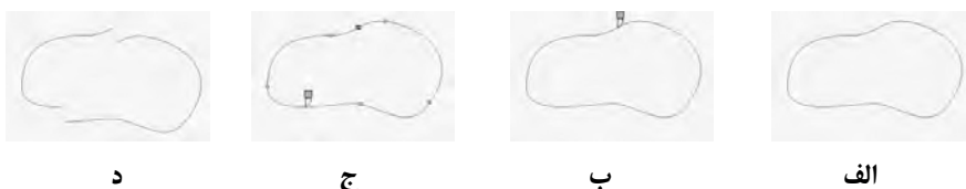
شکل ۷-۹ مراحل برش یک دایره با مسیر منحنی ابزار چاقو
