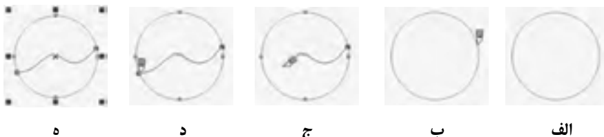
شکل ۶-۹ مراحل برش یک دایره با مسیر منحنی ابزار چاقو
