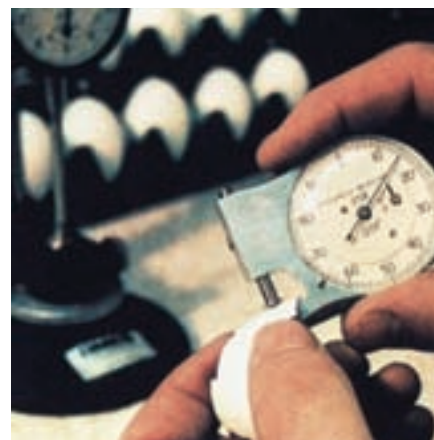
تصویر ۲۵-۱- اندازه‌گیری ضخامت پوسته با میکرومتر
