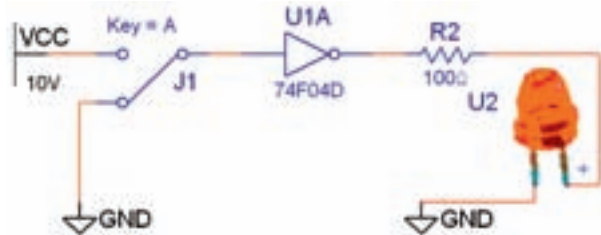
شکل ۱-۲۱ مدار گیت منطقی NOT در حالتی که کلید A قطع است.
