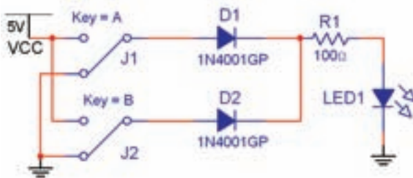
شکل ۱-۴ مدار دیودی گیت OR در حالتی که هر دو کلید A و B قطع است.
