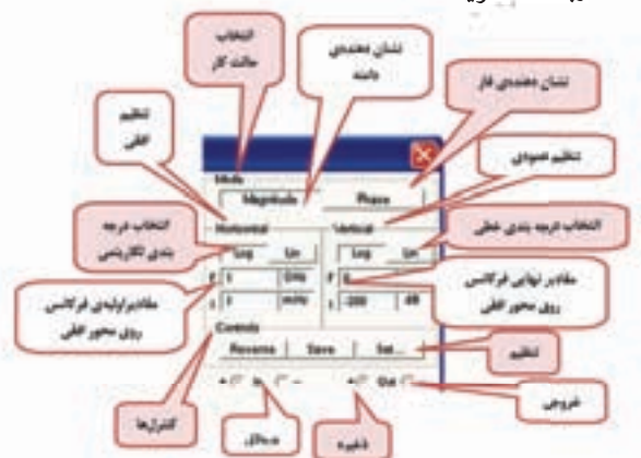
شکل ۴-۵ تنظیم های دستگاه Bode Plotter
