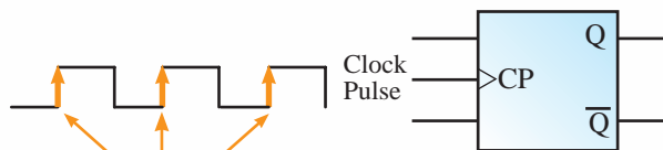
شکل ۲۲-۵- فلیپ‌فلاپ عامل با لبه بالا رونده پالس ساعت
