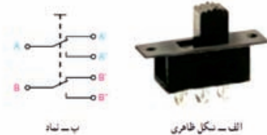
شکل ۶-۱ تصویر کلید تبدیل دوبل و نماد فنی آن
