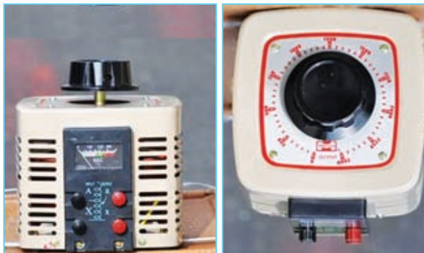
شکل ۶۶- نمای ظاهری و شماتیک اتوترانسفورمر متغیر (واریاک)
