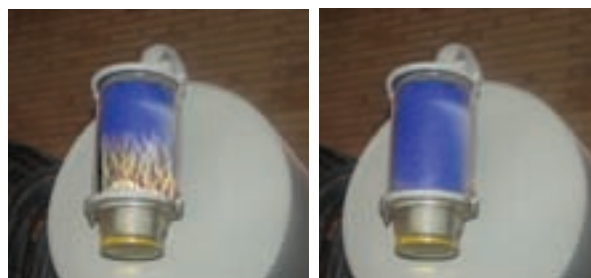
شکل ۲۷-رنگ ماده رطوبت گیر قبل و بعد از جذب رطوبت
