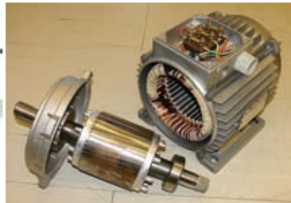
شکل ۲ - اجزای تشکیل دهنده یک موتور القایی
