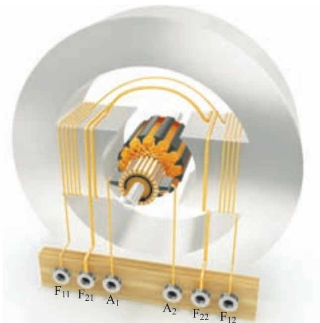
شکل ۳-۳۵ طرح ساختمانی ژنراتور کمپوند
