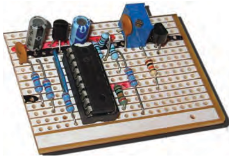
شکل ۱-۳۹- یک نمونه مدار کامل روی فیبر سوراخ‌دار
