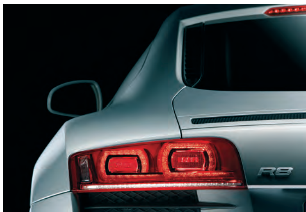
شکل ۵-۱- کاربرد LED پر نور در چراغ خطر اتومبیل
