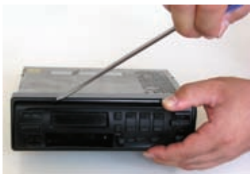
شکل ۲-۳۱- نحوه خارج کردن نادرست قاب
