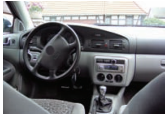
شکل ۲-۱- محل نصب رادیو پخش روی پانل جلویی
