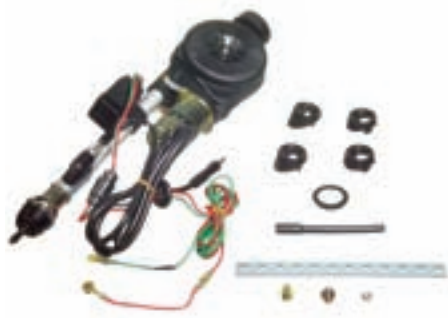
شکل ۲-۱۹- آنتن الکتریکی قابل نصب در گل‌گیر خودرو و متعلقات آن
