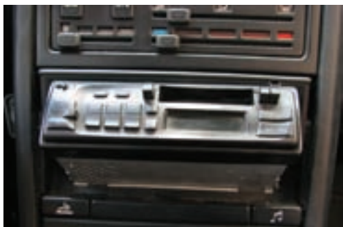
شکل ۲-۳۰- نصب محکم دستگاه
