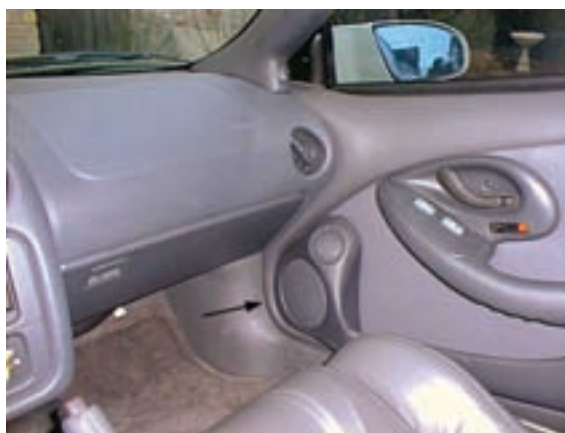
شکل ۲-۱۰- محل نصب بلندگو
