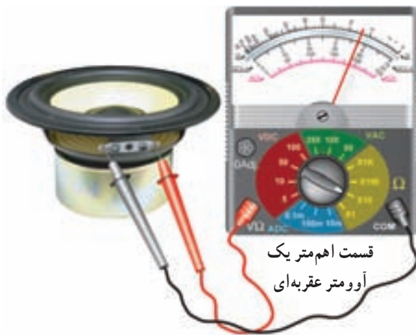
شکل ۵-۱۳- اندازه‌گیری مقاومت اهمی بلندگو با اهم‌متر
