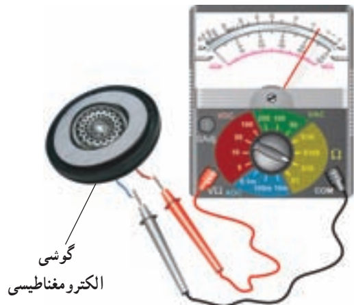
شکل ۵-۱۲- نحوه اتصال گوشی الکترومغناطیسی به اهم‌متر
