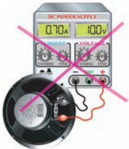
شکل ۵-۱۱- ولتاژ DC را مستقیماً به بلندگو وصل نکنید.
