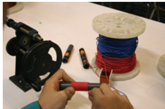
شکل ۹-۸-۱ یک نمونه دیگر سلف 300\ \mu\text{H}
