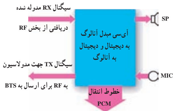
شکل ۲۵-۱۹- ورودی‌ها و خروجی‌های IC در بخش AF
