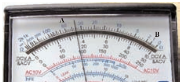
شکل ۲-۲۲- منطقه مناسب برای خواندن مقدار مقاومت
