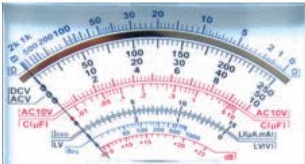
شکل ۲-۱۲- صفحه مدرج و علائم روی آن در مولتی متر آنالوگ
