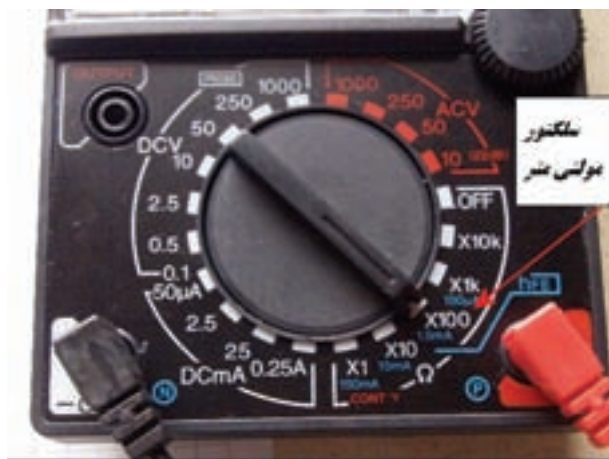
شکل ۱۴-۲- یک نمونه کلید سلکتور مولتی متر عقربه‌ای
