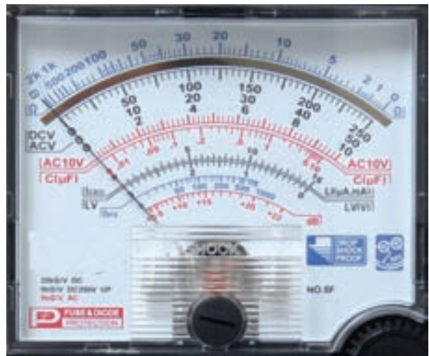
شکل ۲-۱۵- صفحه مدرج یک نمونه مولتی متر آنالوگ
