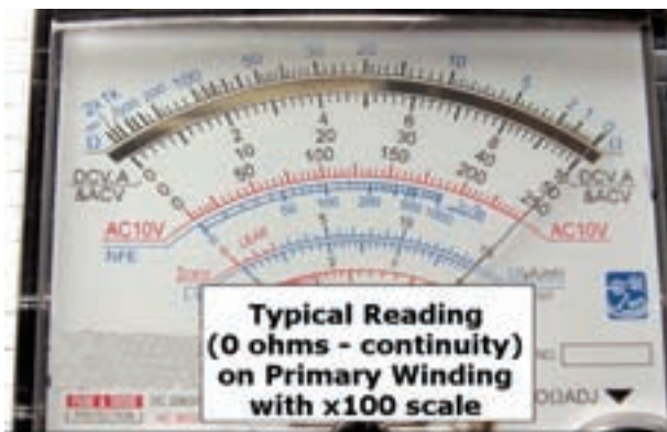
شکل ۲۳-۲- آزمایش پیوستگی یا برقراری اتصال کوتاه
