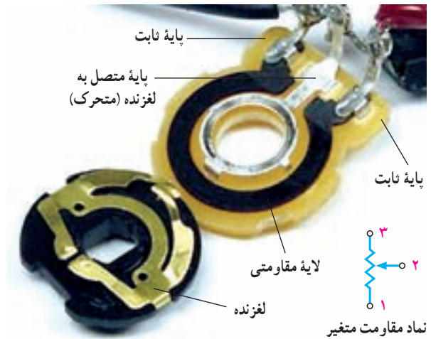
شکل ۲-۳ ساختمان داخلی مقاومت
