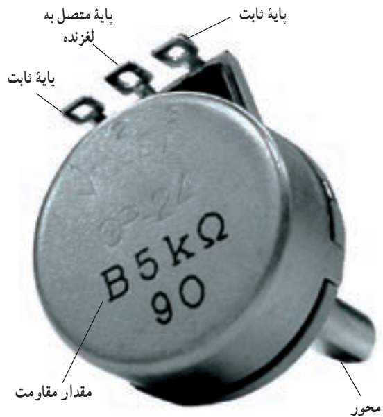
شکل ۳-۳ مقدار نوشته شده روی مقاومت
