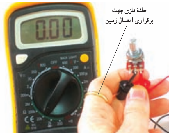
شکل ۳-۸- اتصال مقاومت متغیر به مولتی‌متر دیجیتالی
