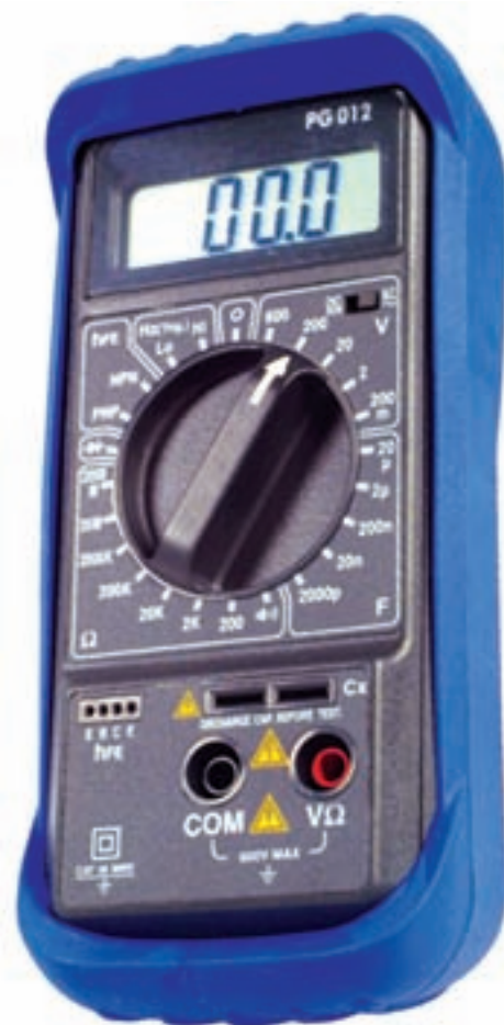
شکل ۱۰-۴- مولتی‌متری که فرکانس را اندازه می‌گیرد
