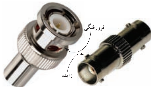
شکل ۱۴-۴ فرورفتگی و زائیده در فیش‌های BNC
