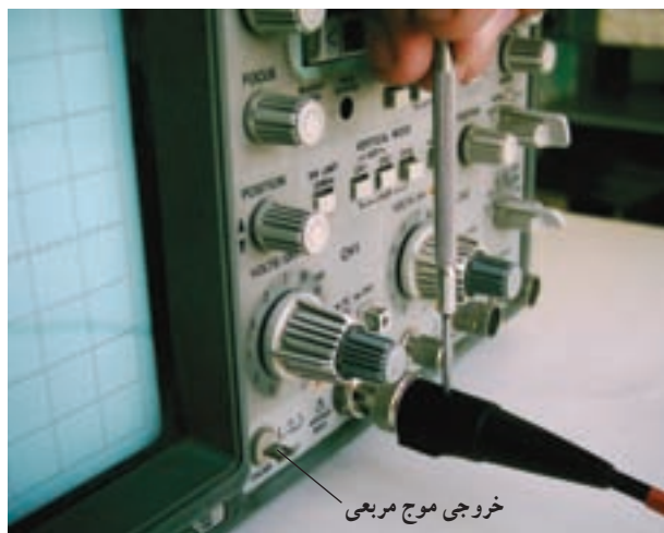
شکل ۱۳-۵ نحوه تنظیم پروب برای مشاهده موج مربعی خروجی موج مربعی
