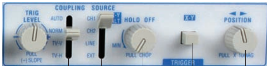
شکل ۱۹-۵ قسمت افقی اسیلوسکوپ
