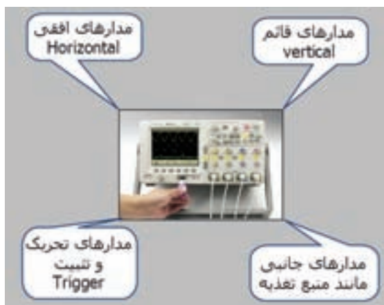
شکل ۵-۷- مدارهای داخلی اسیلوسکوپ
