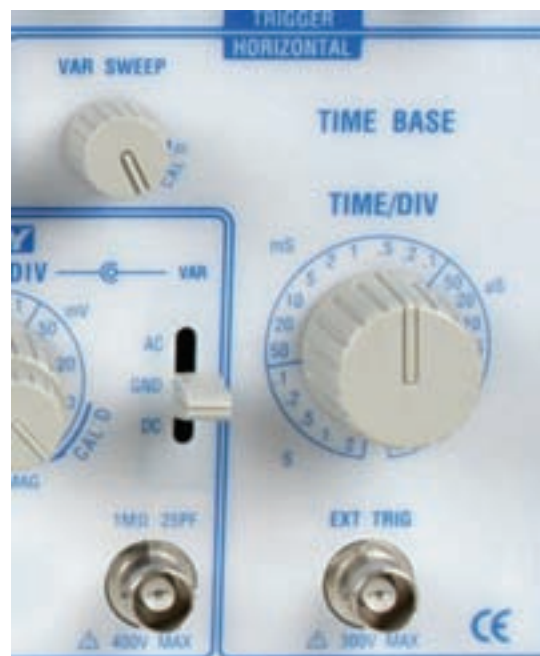
شکل ۱۹-۵ قسمت افقی اسیلوسکوپ
