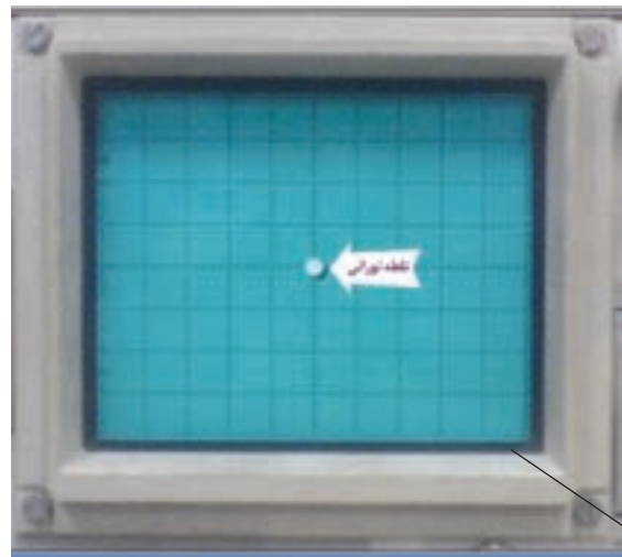
شکل ۵-۵- تولید نقطه نورانی به وسیله اشعه کاتدیک
