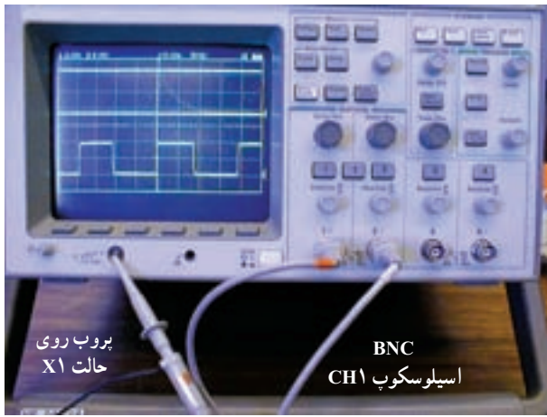
شکل ۲۲-۵- اتصال کانال یک اسیلوسکوپ به ترمینال خروجی مولد موج مربعی
