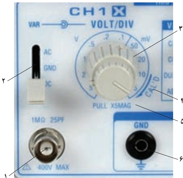
شکل ۱۴-۵- سلکتورها، ولوم‌ها و ترمینال‌های ورودی اسیلوسکوپ
