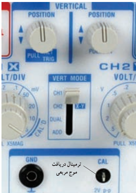
شکل ۱۸-۵- قسمت‌های مشترک و سایر تنظیم‌کننده‌های قسمت عمودی
