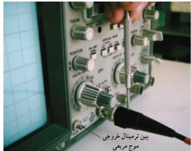
شکل ۲۱-۵- ترمینال خروجی موج مربعی
