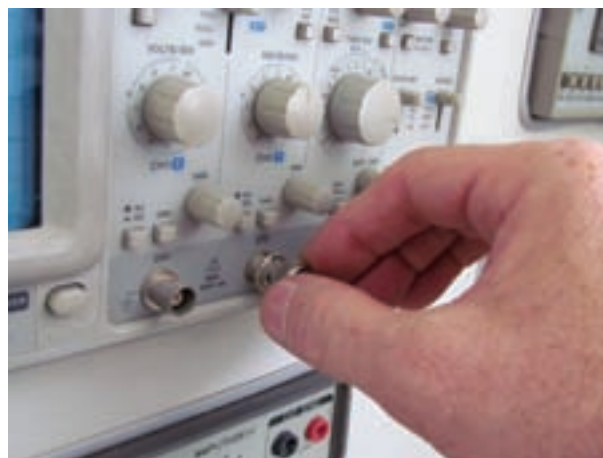
شکل ۱۲-۵ چگونه اتصال BNC به اسیلوسکوپ
