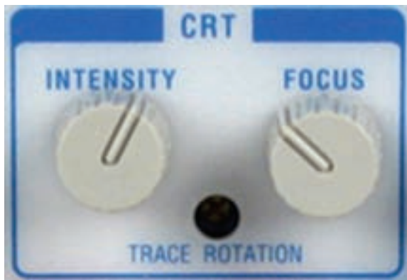
شکل ۵-۶- ولوم‌های تنظیم شدت نور و تمرکز اشعه
