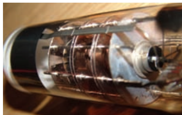
شکل ۴-۵ ساختمان داخلی تفنگ الکترونی
