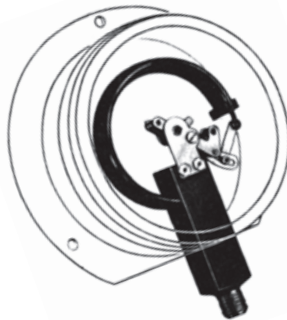
شکل ۱-۹- مکانیزم گیج بوردون
