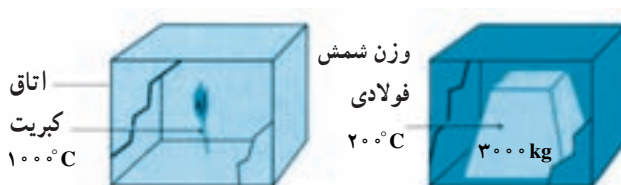
شکل ۱-۱- شعله کبریت درجه حرارت بیشتری را از بلوک فولادی دارد با وجود این بلوک فولادی گرمای بیشتری را در وجود خود دارد و هوای اتاق را بیشتر گرم خواهد کرد.
