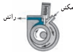
تخلیه کامل شده است آنگاه گاز مکش محبوس می‌شود و سیکل برای تکرار آماده است.
