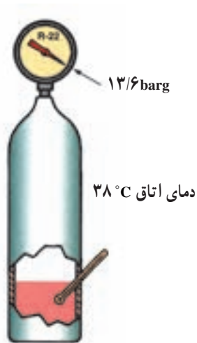
شکل ۲-۱۶- در دمای 38^{\circ}\text{C} فشار نسبی 13/6\text{ barg} است.
