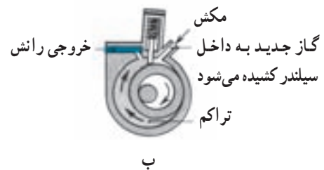
درست در زمانی که گاز محبوس شده متراکم می‌شود، گاز جدید به داخل سیلندر کشیده می‌شود.
