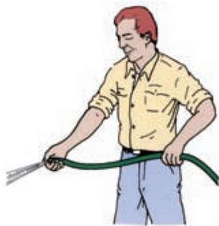
شکل ۱-۵- با کم کردن مقطع عبور افت فشار حاصل می شود
