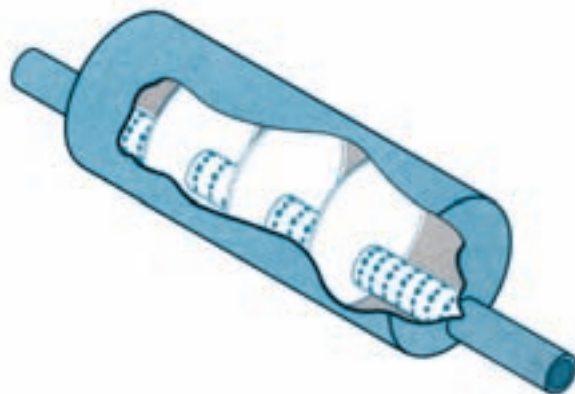
شکل ۷-۱- شکل برش خورده‌ی یک موفلر (صدا خفه‌کن)
