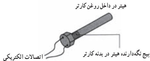
شکل ۷-۲۹- چند نوع هیتر روغن کارتر کمپرسور
