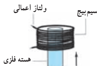
شکل ۱۱-۷- سیم پیچ به علاوه هسته فلزی شیر برقی
