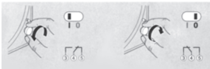
شکل ۹-۱۱- یک نمونه تایمر دیفراسست مورد استفاده در سیستم‌های تبرید تجاری
