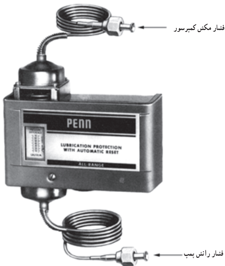
شکل ۹-۲۳- کنترل فشار روغن
