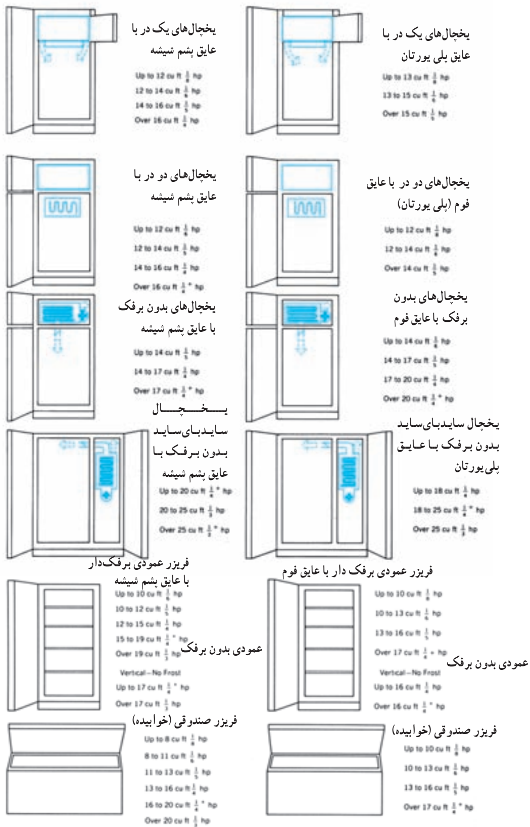
شکل ۲-۱۲- قدرت کمپرسور برای انواع مختلف یخچال و فریزر با دو نوع عایق پشم شیشه و فوم
