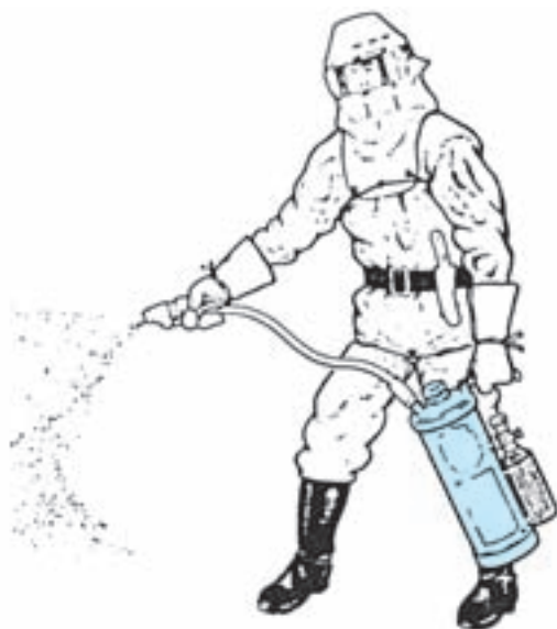
شکل ۴-۱۵- طریق استفاده از پودر خشک شیمیایی
