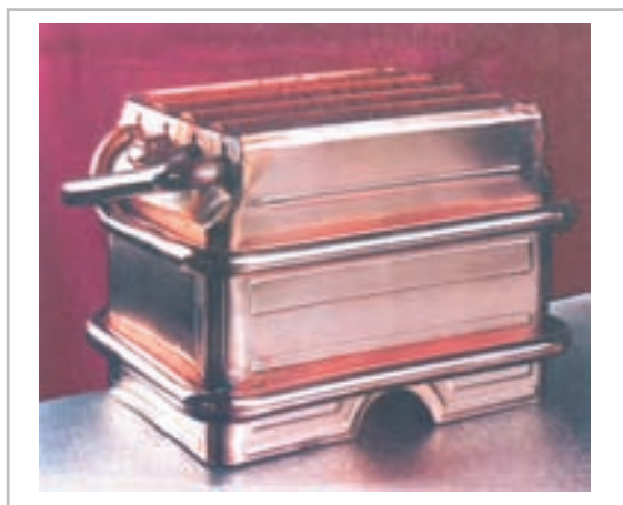
شکل ۱۴-۱۵- مبدل حرارتی پره - لوله قبل از پوشش آلومینیوم / سیلیکون
