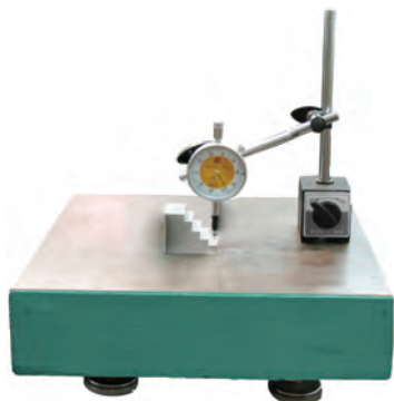
شکل ۱-۶- اندازه‌گیری قطعه‌ی پله‌ای
