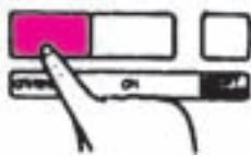
شکل ۹-۸- وصل کلید مربوط به دور معکوس موتور
