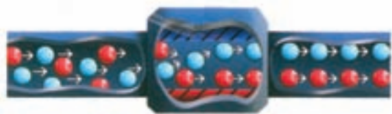
شکل ۴-۱۶- خنثی‌سازی اثر املاح آب توسط جریان مغناطیسی
