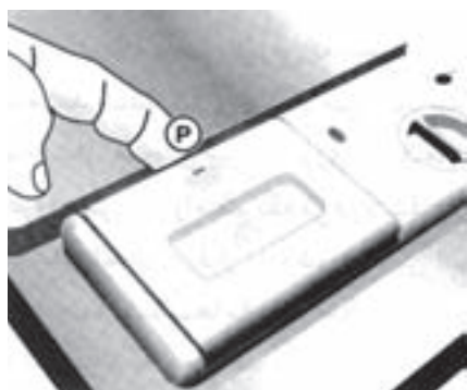
شکل ۱۵-۱۶- طریقه باز کردن درجاپودری اصلی
