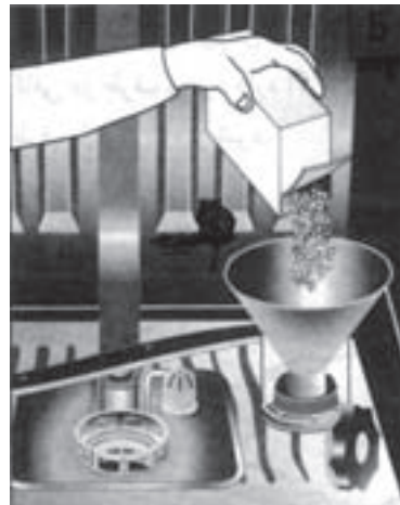
شکل ۹-۱۶- طریقه ریختن نمک در ماشین ظرفشویی اتوماتیک
