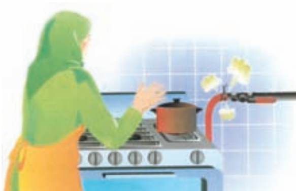
ب) طریقه نصب غلط
