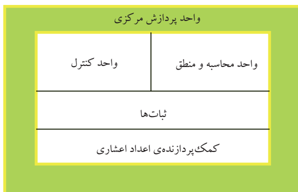
شکل ۸-۱ بخش‌های واحد پردازش مرکزی
