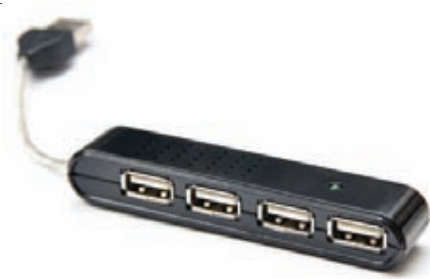
شکل ۲-۳۶ USB Hub با چهار درگاه
