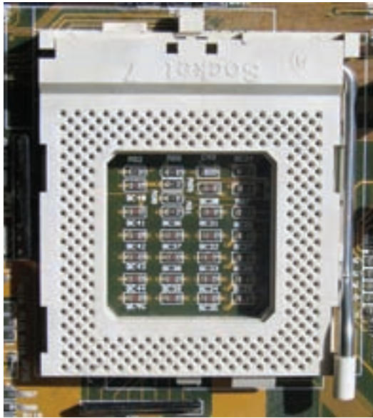
شکل ۲-۷ سوکت پردازنده از نوع ZIF
