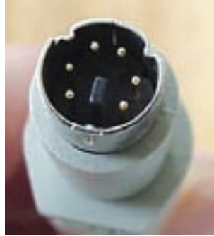
شکل ۱۲-۲ اتصال دهنده‌ی PS/2، سر کابل صفحه کلید
