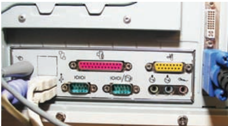
شکل ۳۴-۲ درگاه‌های سبز، درگاه سریال و درگاه قرمز، درگاه موازی است.
