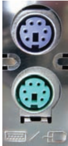
شکل ۱۳-۲ دو کانکتور PS/2 برای اتصال صفحه کلید و ماوس در پشت کیس
