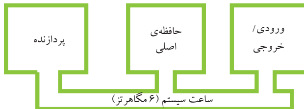
شکل ۲۳-۲ گذرگاه واحد در رایانه‌های اولیه، نسل XT، ساختار اصلی یک گذرگاه و با یک سرعت معین
