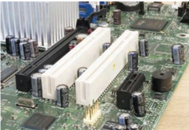
شکل ۳۰-۲ دو شکاف توسعه‌ی PCI به رنگ سفید و دو شکاف توسعه‌ی PCI-E به رنگ مشکی که سمت چپ 16x و سمت راست 1x هستند.
