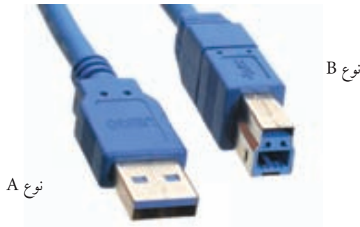
شکل ۳۵-۲ سر کابل‌های رابط USB
