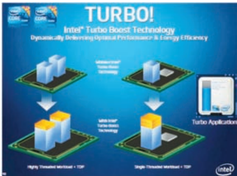
شکل ۴۶-۳ فناوری Turbo Boost در پردازنده‌های چند هسته‌ای سری‌های Core i7 و Core i5
