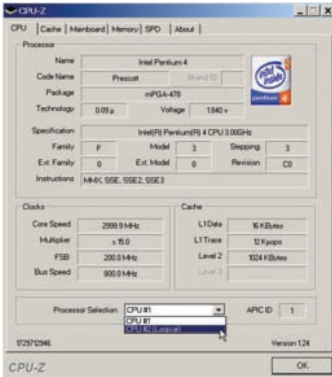
شکل ۶-۳ نمایش مشخصات پردازنده با نرم افزار CPU-Z
