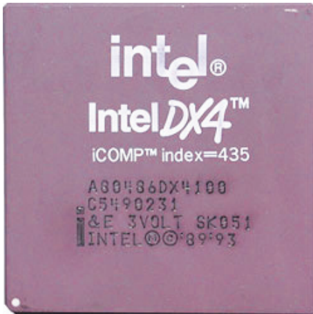
شکل ۲۵-۳ پردازنده ی ۴۱۰۰ DX ۴۸۶ با سرعت ۱۰۰ مگاهرتز و سوکت شماره ی ۳
