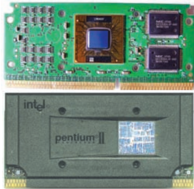
شکل ۳۲-۳ پشت و جلو پردازنده‌ی پنتیوم II با دو تراشه‌ی حافظه‌ی نهان و به صورت شکاف ۱
