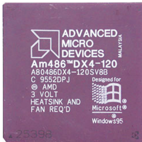
شکل ۲۷-۳ پردازنده‌ی AM486 DX4 از شرکت AMD مشابه خانواده‌ی Intel 486 DX با سرعت ۱۲۰ مگاهرتز
