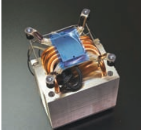
شکل ۴۸-۳ سیستم خنک کننده برای پردازنده‌های نسل Core i
