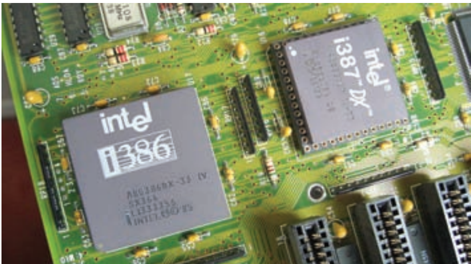
شکل ۱۳-۳ پردازنده‌ی ۸۰۳۸۶ DX و کمک پردازنده‌ی ۸۰۳۸۷ محصول شرکت اینتل
