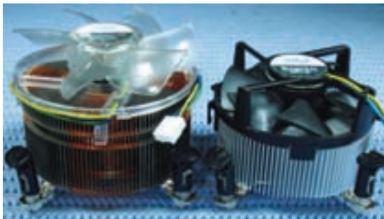
شکل ۳-۴۳ نمونه‌ای از سیستم خنک‌کننده‌ی پردازنده‌های core i7
