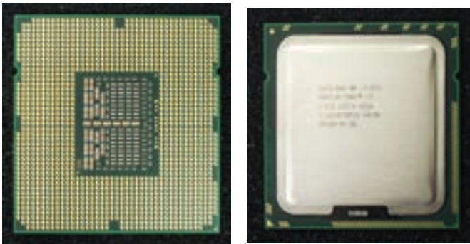
شکل ۳-۴۲ جلو و پشت پردازنده‌ی Intel core i7-975
