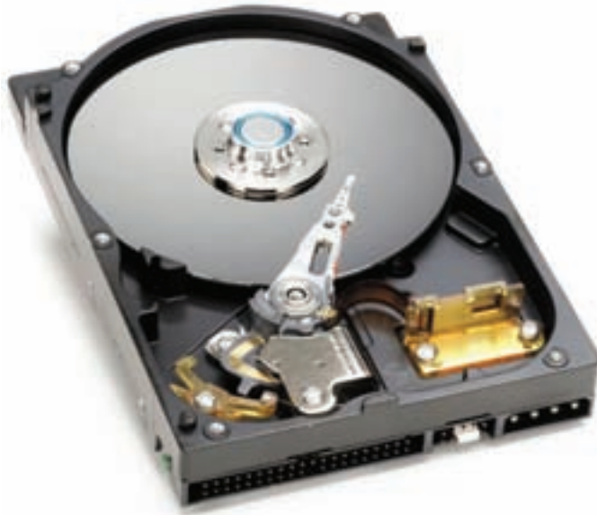
شکل ۲۹-۴ نمای داخلی دیسک سخت
