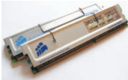
شکل ۴-۱۶ ماژول حافظه ی DDR SDRAM با ظرفیت ۵۱۲ مگابایت و فرکانس ساعت ۴۰۰ مگاهرتز
