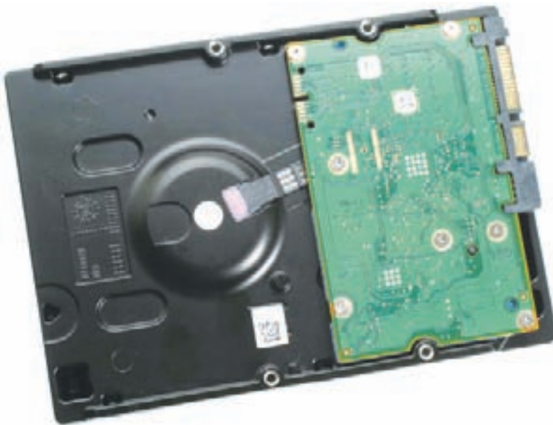
شکل ۴-۴۳ برد مدار چاپی روی دیسک سخت. کنترلر روی این برد وظیفه‌ی تبدیل داده‌های خوانده شده به داده‌های قابل فهم برای رایانه را دارد.
