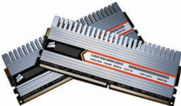
شکل ۴-۱۷ حافظه ی اصلی DDR2 با ظرفیت یک گیگابایت و فرکانس پالس ساعت ۸۰۰ مگاهرتز
